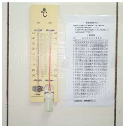
圖 34 乾球溼球溫溼度計
