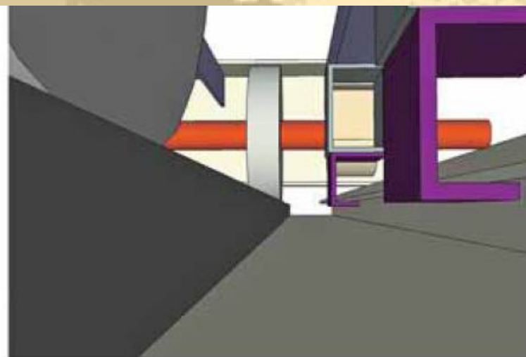
圖 67 密集式檔案架防傾倒卡榫示意圖
